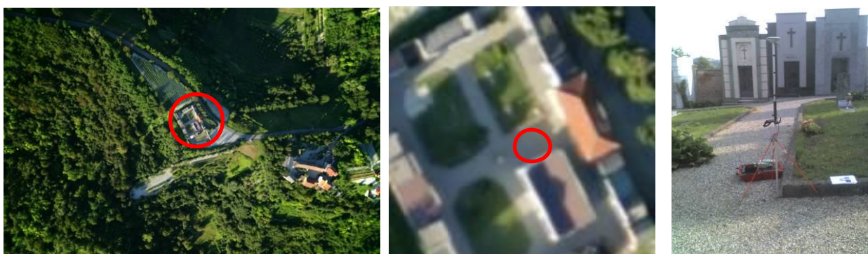
Fig. 10 - Localizzazione del punto sul fotogramma e fase di acquisizione
