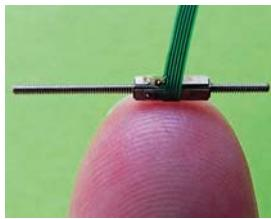
Fig.11. Piezo motor [17]
