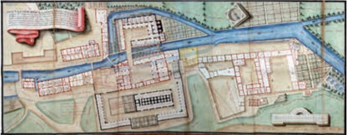
151. Magnifica e dettagliatissima pianta (1814) della zona industriale dei Molassi. Da sinistra a destra: filatoio Galeani (a destra del canale), filatoio Pinardi (a sinistra), mulini della Città (su entrambi i lati). In rosso gli edifici preesistenti, in nero quelli di recente costruzione o in progetto; in basso al centro del disegno, i forni per il pane.
