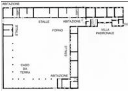
Pianta della cascina Marchesa con chiara distinzione tra l'area produttiva, attorno al cortile, e la villa padronale.
