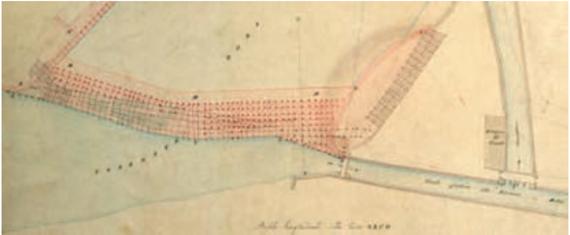
Sopra: pianta del 1840 con l'indicazione dei pali infissi nell'alveo della Dora per rifare la diga di derivazione del canale Meana. Sotto: paratoio del partitore del canale della Pellerina, in località Martinetto.
