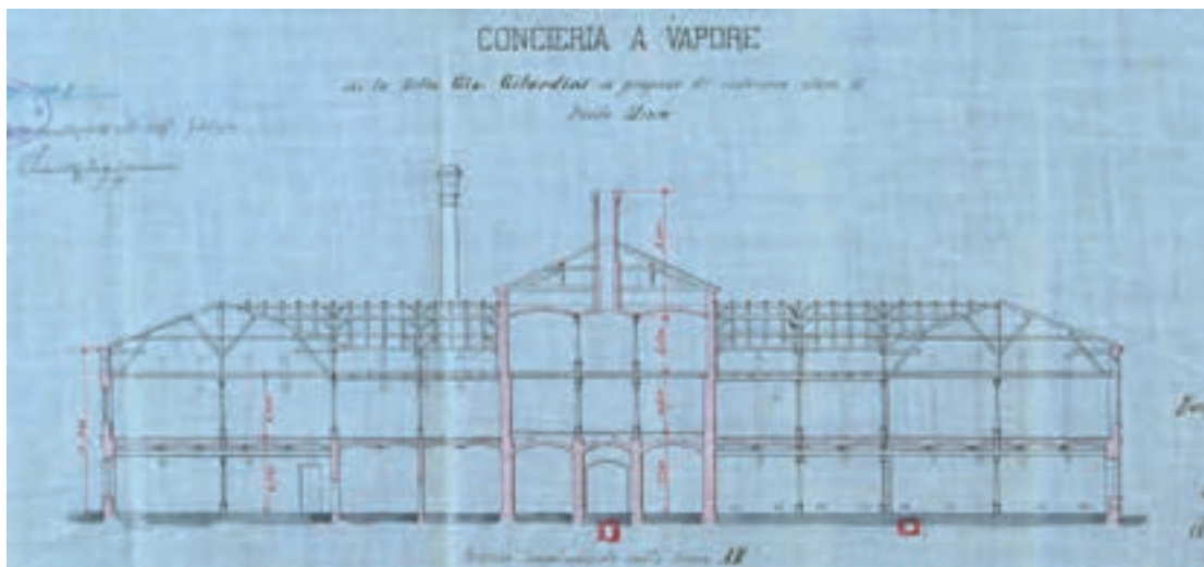
160. Disegno di progetto di uno degli edifici della conceria Gilardini (1876).
