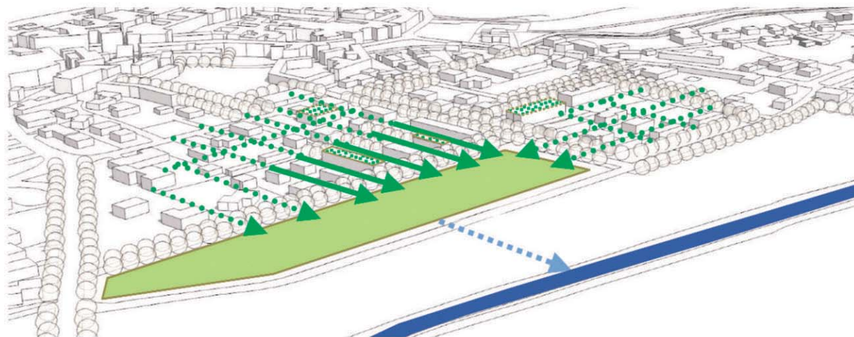
Schema B: fasce ed aree di permeabilità in funzione del convogliamento dei drenaggi in aree verdi di smaltimento localizzate in maniera diffusa nell'insediamento.
