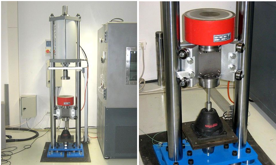
Figura 5 – Sistema di prova dinamica ad urto degli antivibranti
