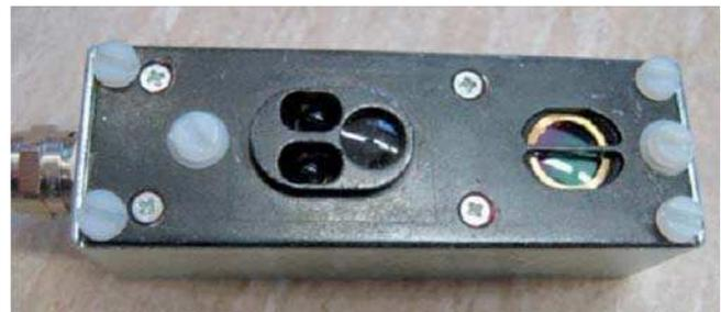
Fig. 9 - Sensore infrarosso attivo e passivo. *Active and passive infra-red sensor.*
