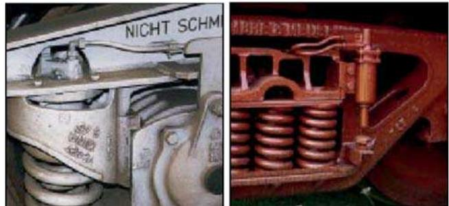
Fig. 15 - Esempio di cella di carico, a sinistra, e valvola elettro-pneumatica, a destra, per la rilevazione del carico del veicolo. *Example of a load cell (LH) and electro-pneumatic valve (RH) to detect the load of the vehicle.*
