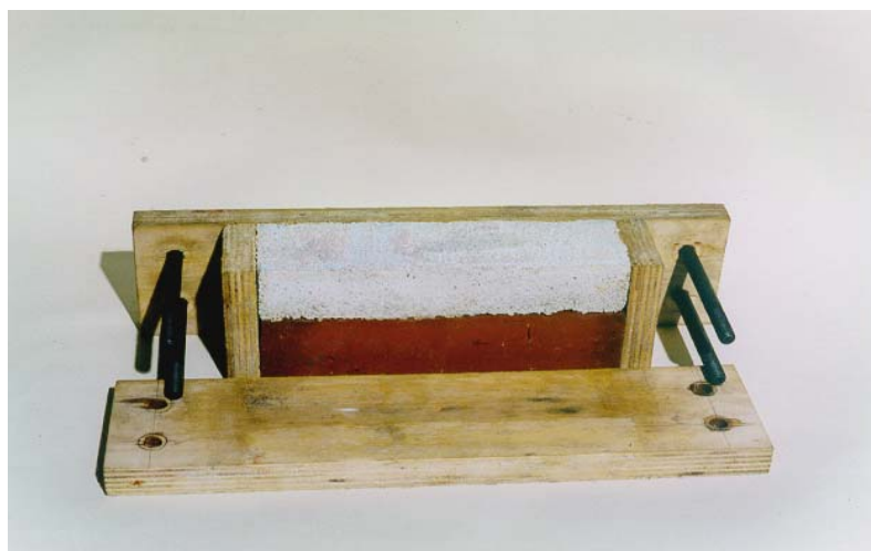
Figura 4.5 – Casseri di legno per il confezionamento dei provini misti malta-laterizio.
