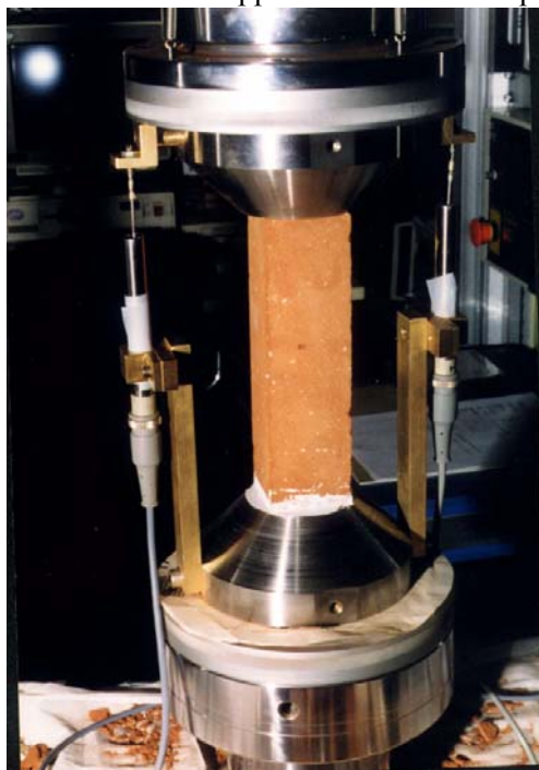
Figura 3.1 – Disposizione del provino e sistema di misura degli spostamenti
