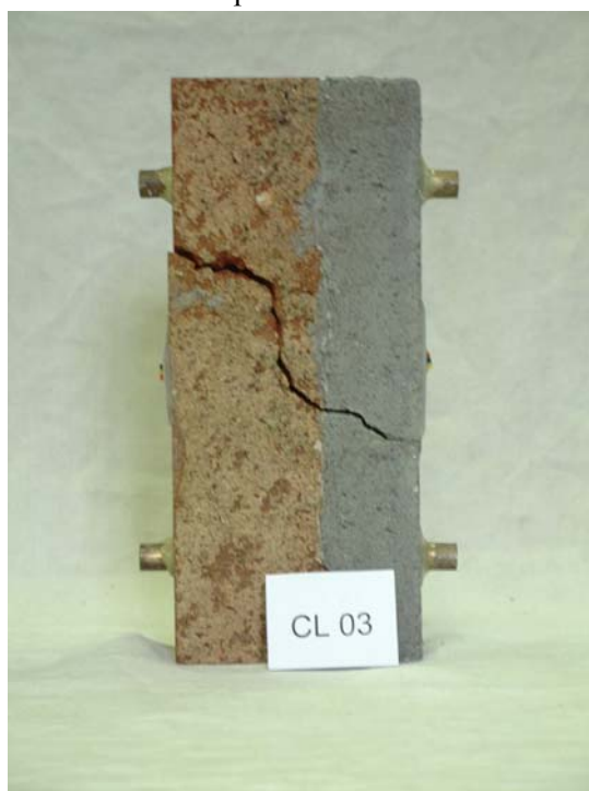
Figura 5.1 – Campione misto CL dopo prova 25 cicli gelo-disgelo
