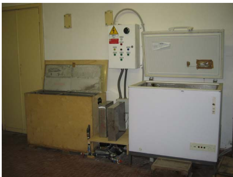
Figura 4.13 – Apparecchiatura per i cicli di gelo-disgelo
