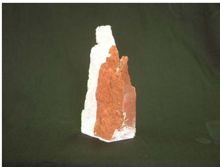
Figura 5.12 – Rottura provino AL01 dopo sollecitazione ciclica
