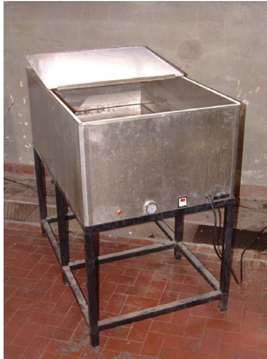
Figura 4.11 – Bollitore utilizzato per la prova di assorbimento d'acqua
