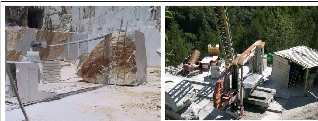
Fig.1-2: Riquadratura con tagliatrice e telaio a filo
