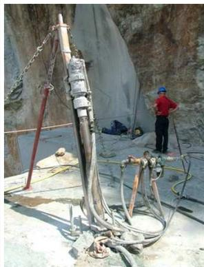
*Fig.1: Perforatrice con spurgo d'acqua*
