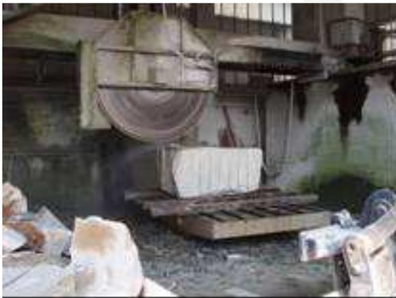
Fig.3: Taglio blocchi con segatrice monolama gigante compartimentata
