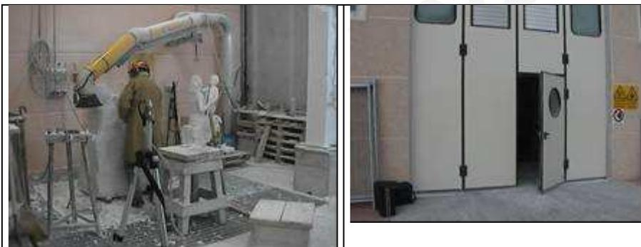
*Fig.5-6: Cappe aspiranti orientabili (3) e griglia a pavimento (4)*
