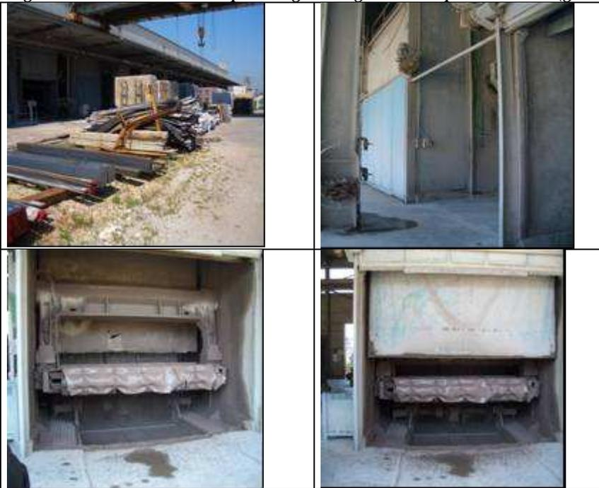
**Fig.9-10: Batteria di telai per il taglio dei graniti in box aspirati (grande azienda - Veneto)**
