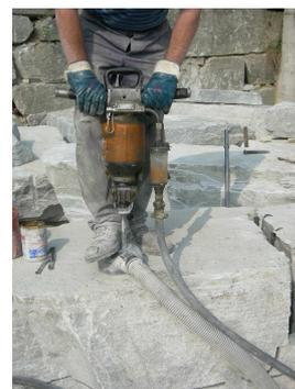
*Fig.1-2-3: Perforazione manuale classica e con aspirazione a boccaforo*
