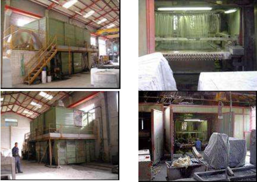
**Fig.5-6-7-8: Batteria di telai per il taglio dei graniti incapsulati in box (grande azienda - Toscana)**
