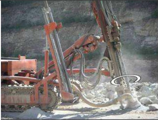
Fig.2: Perforatrice con aspirazione a boccaforo
