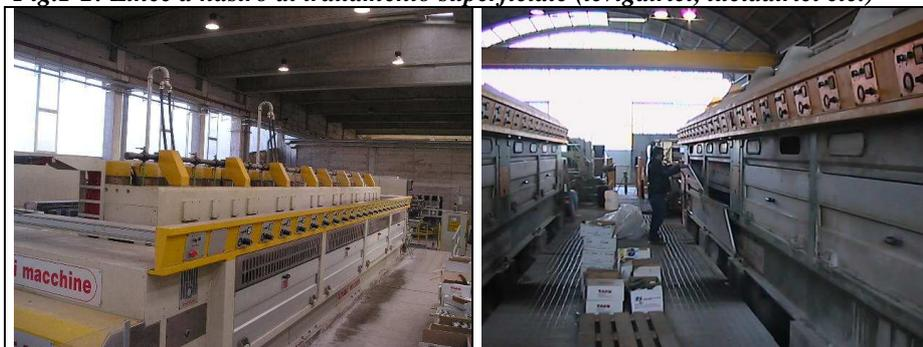
**Fig.3-4: Bocciardatrici cabinate con ugelli erogatori di acqua nebulizzata**
