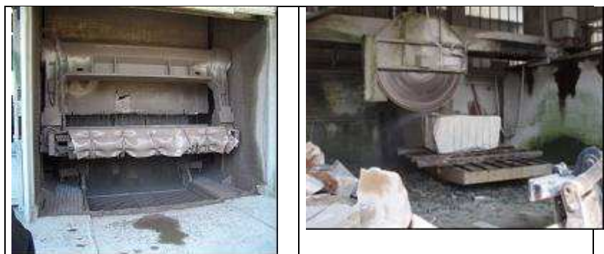
Fig. 1: Taglio blocchi con telai multilame e con tagliatrici a disco
