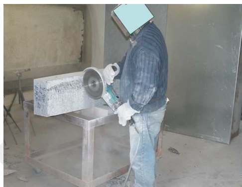
Fig.1: Finitura manuale con fresatrici a disco
