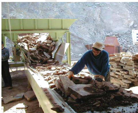
Fig.3: Bagnatura tramoggia di banco di cernita porfido
