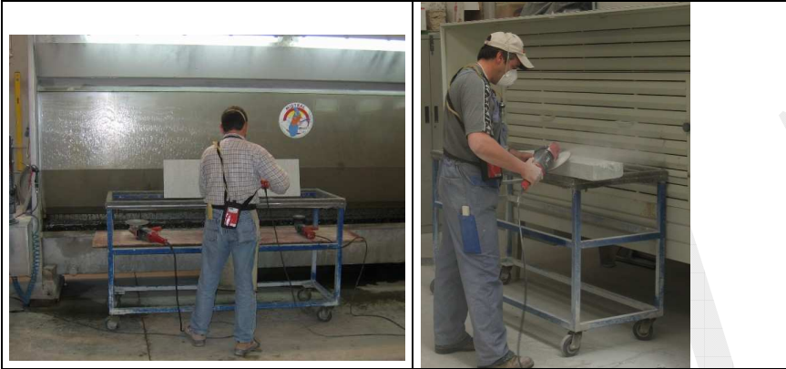
Fig.3-4: Parete ad acqua (1) e parete multifessura aspirati (2)
