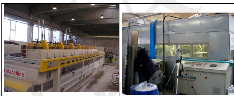
Fig.1: Linee di trattamento superficiale a nastro e bocciardatrice
