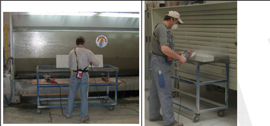
Fig.3-4: Parete ad acqua (1) e parete multifessura aspirati (2)
