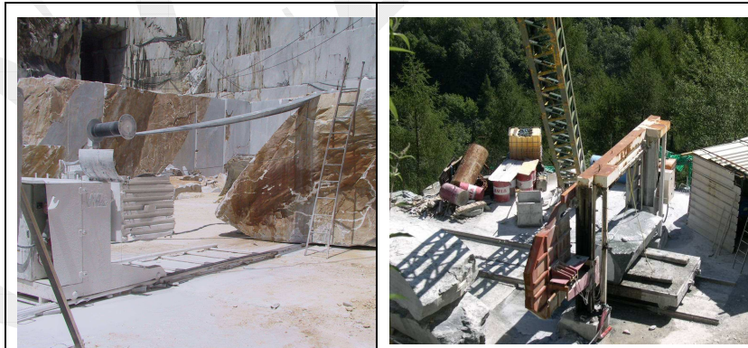
Fig. 1: Riquadratura bancata con tagliatrici a filo
