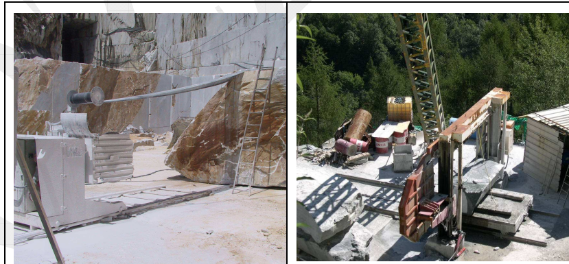
Fig. 1: Riquadratura bancata con tagliatrici a filo
