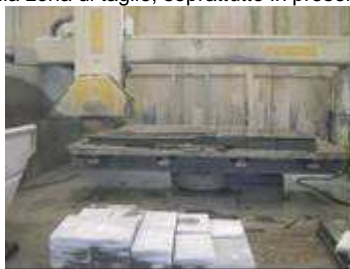
Fig.1: Taglio lastre con segatrici (frese) a ponte ed a bandiera
