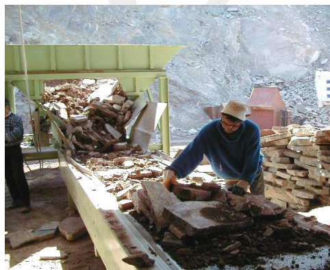
Fig.3: Bagnatura tramoggia di banco di cernita porfido
