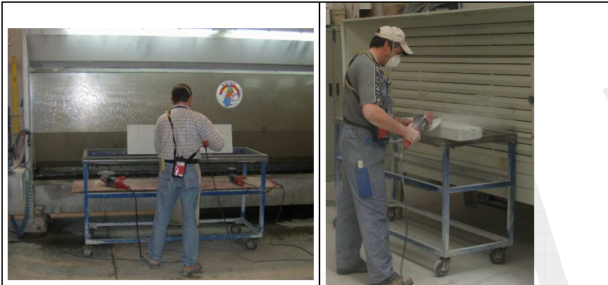
Fig.3-4: Parete ad acqua (1) e parete multifessura aspirati (2)
