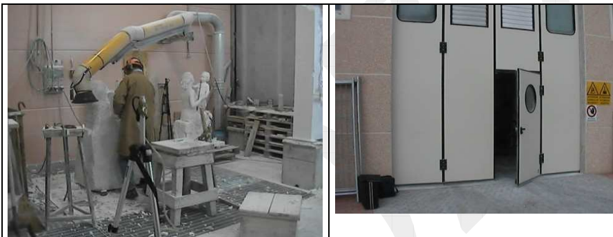
Fig.5-6: Cappe aspiranti orientabili (3) e griglia a pavimento (4)
