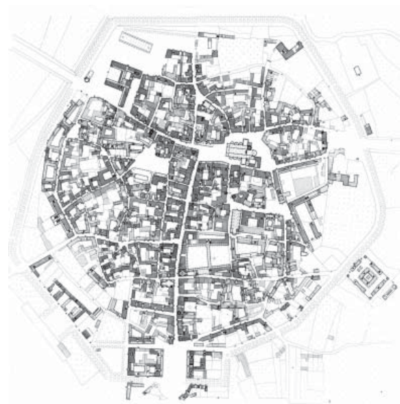
4. Rilievo del tessuto urbano della città di Alba: esempio di applicazione della norma in altre realtà urbane piemontesi. Scala del disegno originale: 1:1000.
