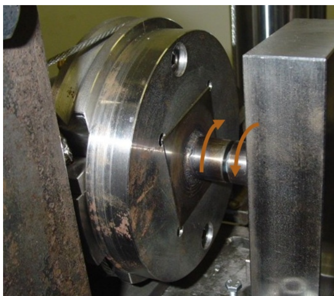
Figura 4: Attrezzatura di carico per le prove di torsione (per entrambi i provini, mostrata per il caso di provino a sezione circolare); tramite un sistema di funi e pulegge il moto rettilineo generato su di una macchina di prova universale viene convertito in rotazione delle flange di carico (l'altra è fissa e costituisce vincolo torsionale)
