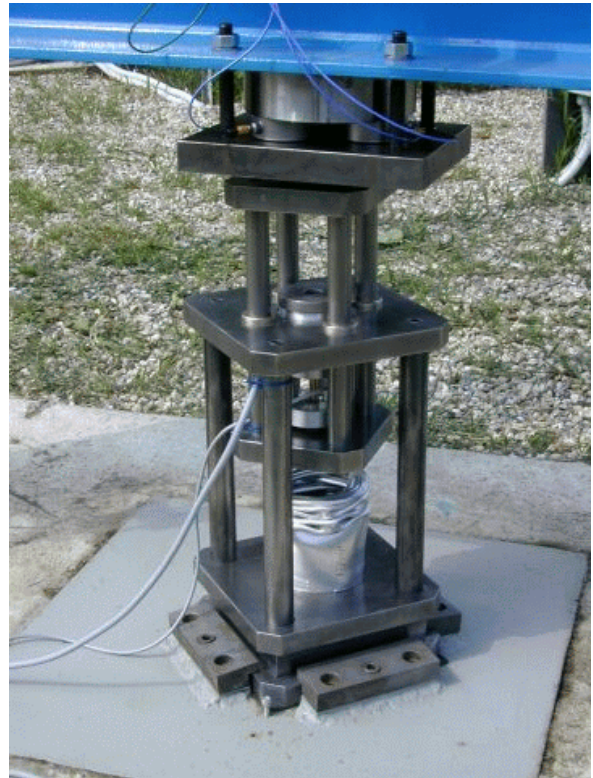
Fig. 4 - Provino montato sull'attrezzatura di carico
