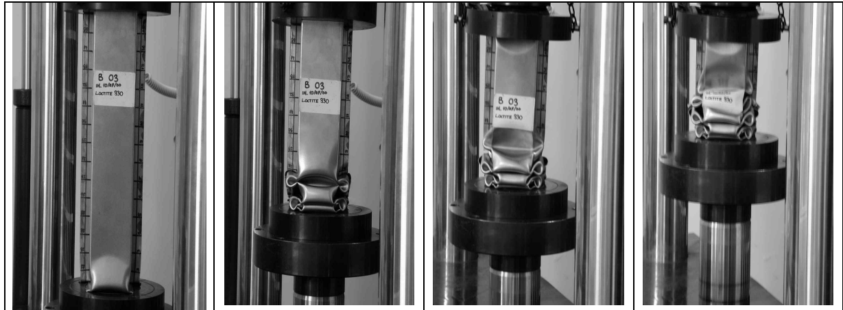
Fig. 4 Immagini in sequenza della configurazione deformata della trave B3 durante il collasso assiale
