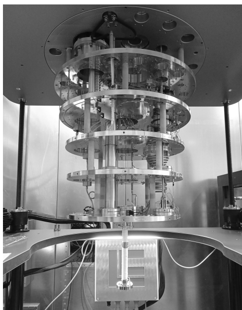
Figura 3: Il criomagnete a diluizione per gli esperimenti QAHE presso l'INRIM. Il portacampioni è all'estremo inferiore del sistema ed è inserito nel criomagnete a 9 T.
