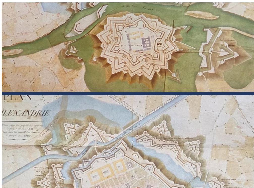
Fig. 3- Particolari dell'ultimo progetto di Chasseloup-Laubat del 1808 in cui sono ben delineate le varie opere di canalizzazione dei percorsi fluviali e il bacino di inondazione (Barghini, 1991: p. 57)
