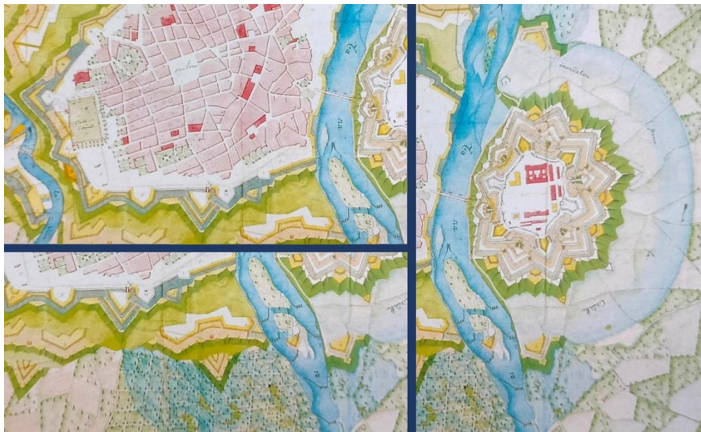
Fig. 1- Particolari del progetto di inizio Ottocento in cui il disegno definisce con attenzione le strutture fortificate e il territorio circostante, comprese le aree di esondazione fluviale (Ratti, 2006: p. 26)
