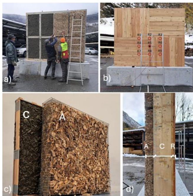
Figura 1 – a) montaggio strato fonoassorbente; b) punti di misurazione R1-R9; c) pannello fonoisolante (C), in cippato integrato nel conglomerato alcali-attivato e pannello fonoassorbente (A) in cippato sfuso; d) composizione della barriera in 3 strati.
