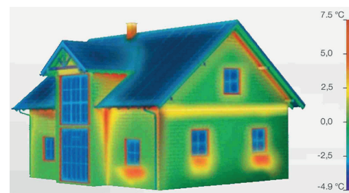
Ponti termici da https://www.portefinestreanger.it/ponti-termici-fattore-temperatura-frsi/
