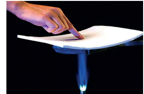
Dimostrazione proprietà isolante di pannelli in aerogel da http://www.geosynthetic-fabric.com/news/aerogel-thermal-insulation-felt-history-46944.html
