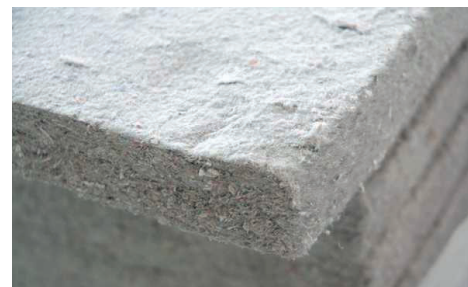
Pannelli in fibra di cellulosa da https://www.ideegreen.it/vantaggi-fibra-di-cellulosa-48899.html
