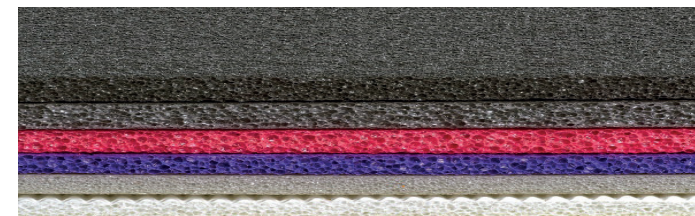
Diversi strati di polipropilene espanso da http://plasticol.it/lavorazione-polietilene-espanso
