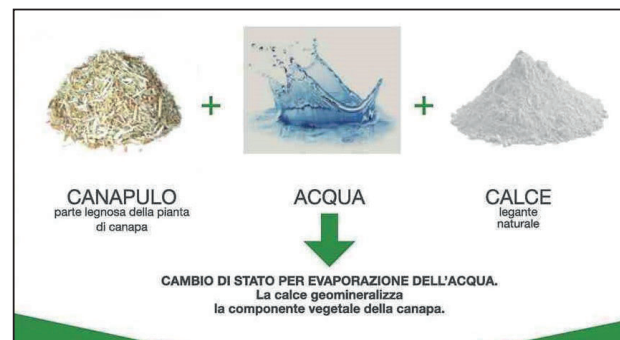
Schema sintetico delle materie prime costituenti il conglomerato a base di calce e canapa da https://www.equilibrium-bioedilizia.it/it
