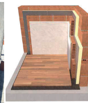
Isolamento termico in intercapedine da https://www.knaufinsulation.it/applicazioni/pareti-perimetrali
