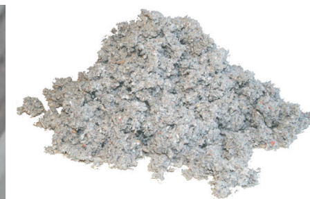
Fiocchi in fibra di cellulosa da https://www.isolare.it/it/prodotti/isolante-naturale-fibra-cellulosa
