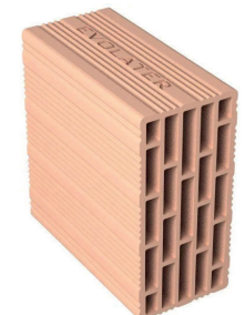
Blocco in laterizio per tamponamento, dimensioni: 30 x 25 x H 24,5 cm e 14,3 kg, raggiunge valori termici ideali: (sp. 45 cm, U = 0,21 W/mqk) da https://www.edilportale.com/prodotti/pareti-esterne-e-facciate/blocchi-pannelli-e-lastre-per-pareti-esterne/blocchi-da-muratura-in-laterizio/91
