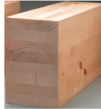
Sezione di legno lamellare da http://arredamento-online-glossario-figurato.blogspot.com/2015/05/legno-lamellare-incollato.html
