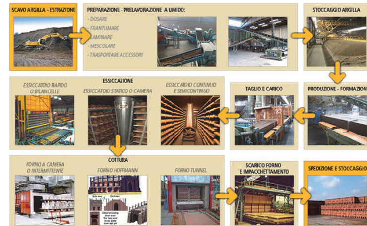
Ciclo produttivo dei laterizi da https://www.ballatoreimpianti.it/wp-content/uploads/2019/01/ciclo_produttivo1.pdf
