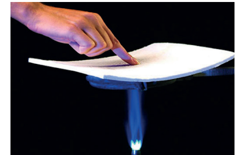
Dimostrazione proprietà isolate di pannelli in aerogel da http://www.geosynthetic-fabric.com/news/aerogel-thermal-insulation-felt-history-46944.html
