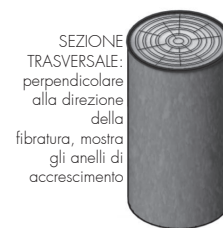
Sezioni anatomiche del legno rielaborazione da https://file.didattica.polito.it/download/MATDID
