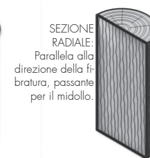
Sezioni anatomiche del legno rielaborazione da https://file.didattica.polito.it/download/MATDID
