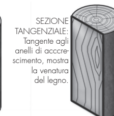
I vari tagli del legno rielaborazione da https://warhodgconqua.cf/vi220-terminale-per-la-lavorazione-del-legno-manuale
