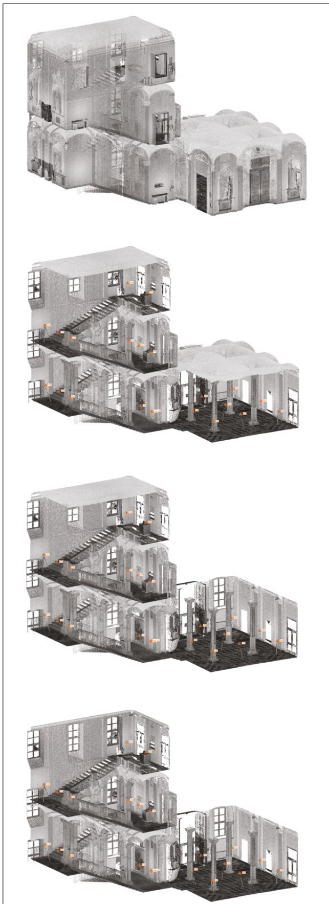
fig. 8 – Scomposizione della nuvola di punti. Tale processo permette di isolare porzioni o singoli elementi architettonici dal complesso rilevato. I triangoli rappresentano i punti di stazione della strumentazione utilizzata (elaborazione di M. De Chiaro e P. Guerreschi, 2020).
