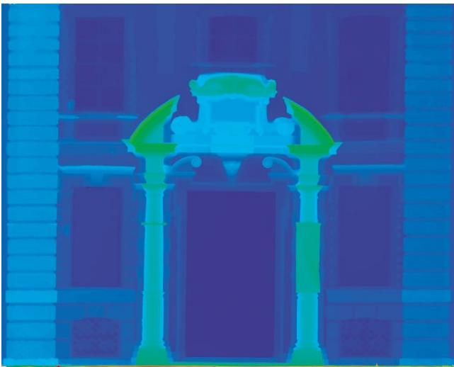
fig. 5 – Modello digitale di elevazione rappresentate l'oggetto degli elementi costituenti il portale. I colori freddi indicano il livello della facciata, quelli più caldi mettono in evidenza gli avancorpi dell'apparato decorativo (elaborazione di M. De Chiaro e P. Guerreschi, 2020).
