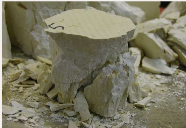
Fig. 13. Un provino a test effettuato e rottura avvenuta
