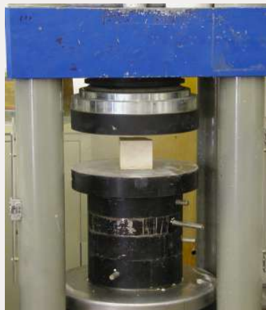
Fig. 11. Posizionamento del provino all'interno della macchina per realizzare il test di resistenza a compressione
