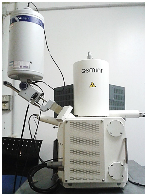
Fig. 25: FESEM Supra 40 instrument.
