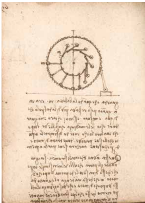
Fig. 8 - Leonardo, Studio di ruota perpetua , Codice Forster II, f. 90v. London, British Museum (da Fac-simile dell'Edizionale Nazionale dei Disegni e dei Manoscritti di Leonardo).
