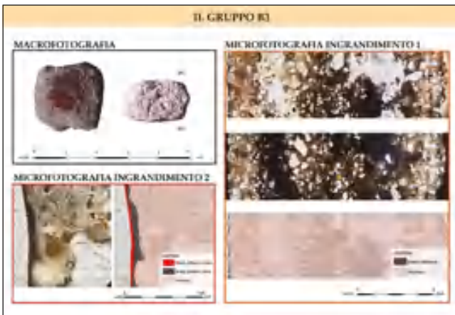
tav. 4 - Fotografie a diverse scale del campione di intonaco del gruppo B3.
