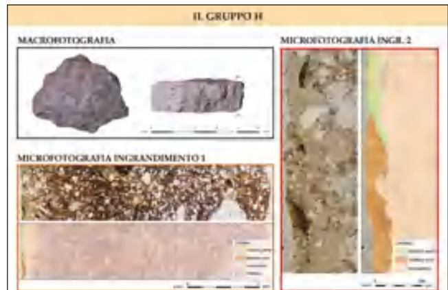
tav. 11 – Fotografie a diverse scale del campione di intonaco del gruppo H.
