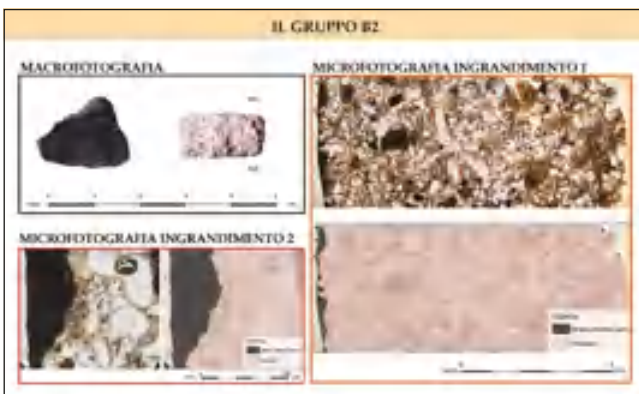
tav. 3 - Fotografie a diverse scale del campione di intonaco del gruppo B2.
