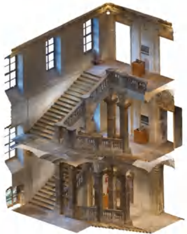
fig. 9 – Restituzione assonometrica di precisione dello scalone principale dell’Ospedale Maggiore su base integrata del rilevamento LiDAR e fotogrammetrico. Si apprezzano in particolare la sequenza ritmica dei pilastri, dotati di ordine, a reggere il sistema voltato; i pianerottoli presentano una pavimentazione in materiali selezionati analoghi a quelli scelti per l’atrio, mentre la sezione sull’assonometria permette di apprezzare gli stucchi che formano cornici di ricca impostazione in corrispondenza dell’accesso alle infermerie (elaborazione di M. De Chiaro e P. Guerreschi, 2020).
