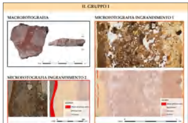
tav. 12 – Fotografie a diverse scale del campione di intonaco del gruppo I.
