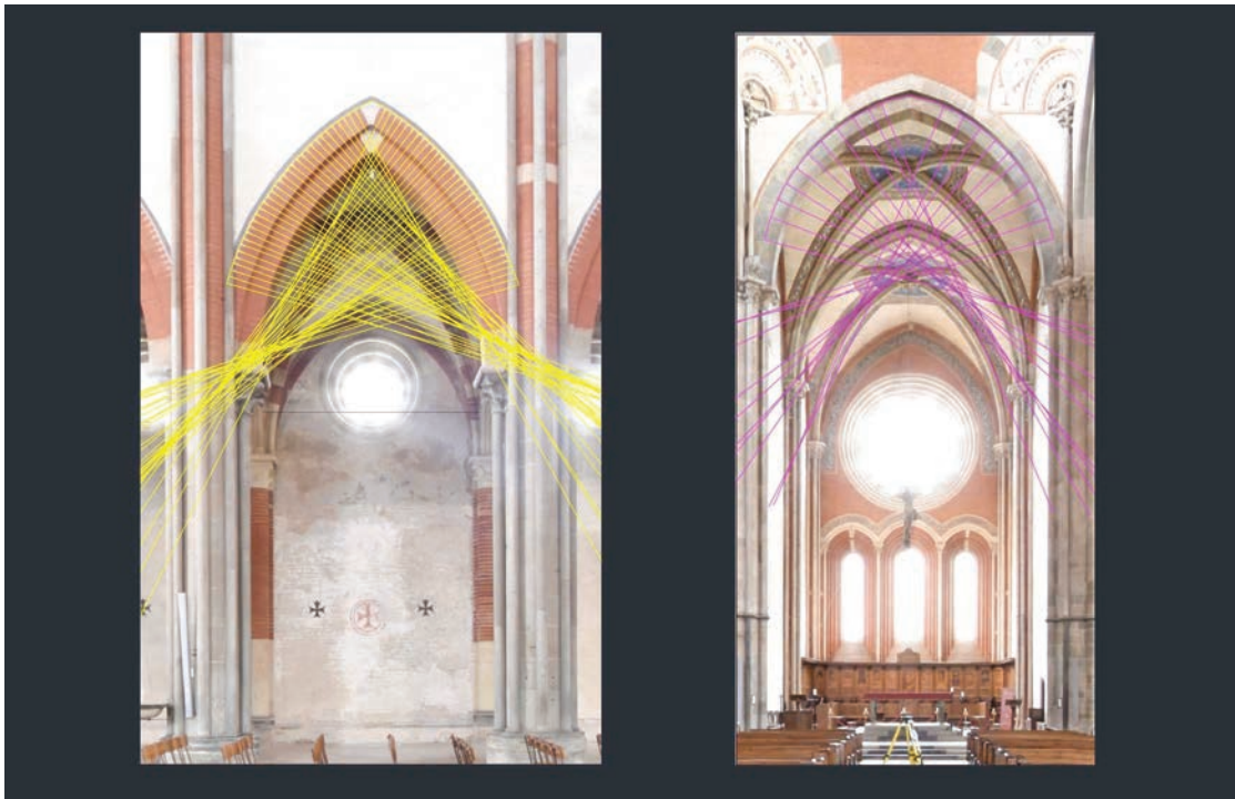
Figura 5 – Analisi tipologica degli archi tramite l'analisi dei centri d'imposta.
