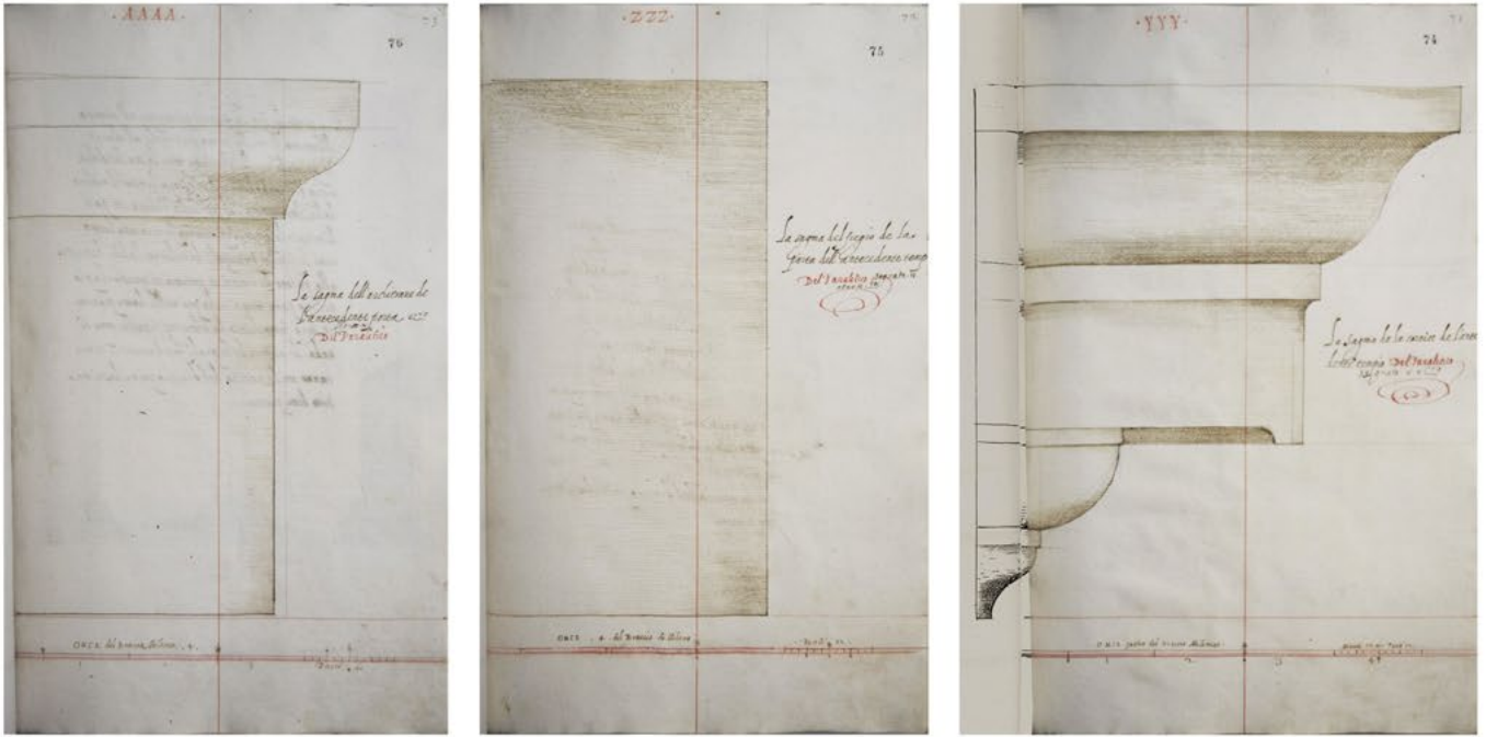
Figura 2.141 - Galeazzo Alessi e collaboratori, Modani dell'architrave, del fregio e della cornice del portale della cappella del Paralitico, LM 76, 75, 74.
