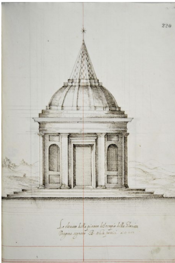
Figura 3.41 - Galeazzo Alessi e collaboratori, Progetto per la cappella della Madonna Tramortita , alzato. LM 220.
