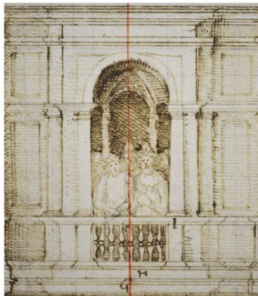
Figura 1.109 - Galeazzo Alessi e collaboratori, Progetto per la Casa di Pilato , sezione, LM 199. Lo schema mostra le diverse fasi di redazione del foglio: 1. Linee di impaginato in inchiostro rosso; 2. Linea di terra e linee di costruzione in stilo metallico; 3. Linee di contorno a penna e inchiostro; 4. Disegno del mistero; 5. Ombreggiature; 6. Segnature e didascalie.
