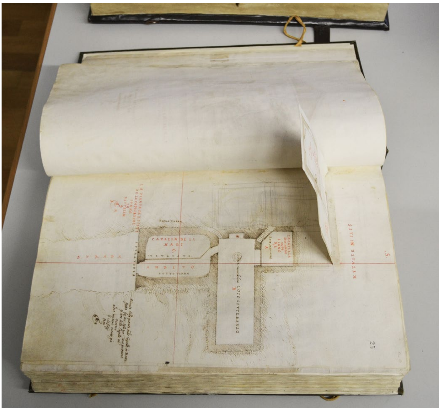
Figura 1.61 - Galeazzo Alessi e collaboratori, Progetto per il complesso di Betlemme , LM 25. Si può notare l'inserito a bandiera utilizzato per mostrare, nello stesso foglio, i due livelli dell'edificio.
