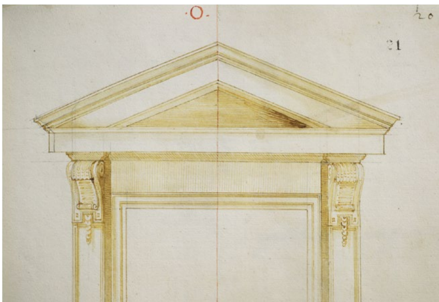
Figura 1.98c - Galeazzo Alessi e collaboratori, Progetto per il portale della cappella dell' Annunciazione . LM 21. In questo foglio è utilizzato l'inchiostro (i. B).
