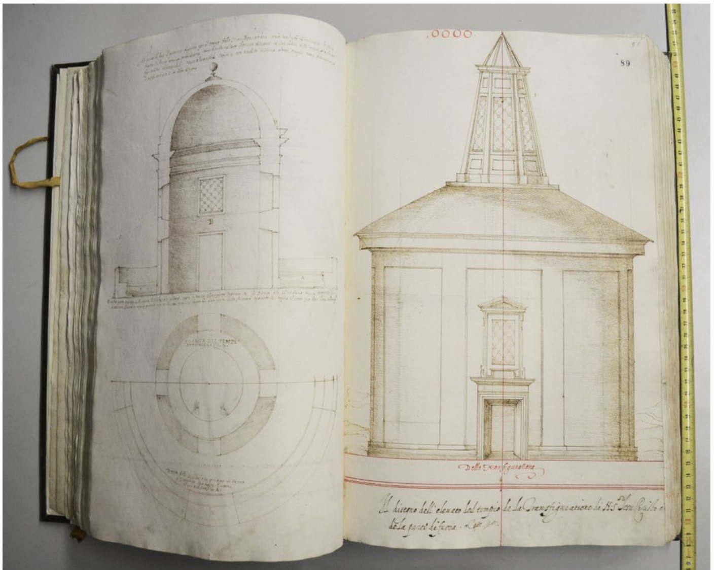
Figura 1.102 - Galeazzo Alessi e collaboratori, Progetto per la cappella della Trasfigurazione . LM 88v, 89. Nel verso del foglio 88 si può vedere la variante disegnata da Galeazzo Alessi per ridurre le dimensioni della cappella e adattarsi alle fondazioni già costruite.
