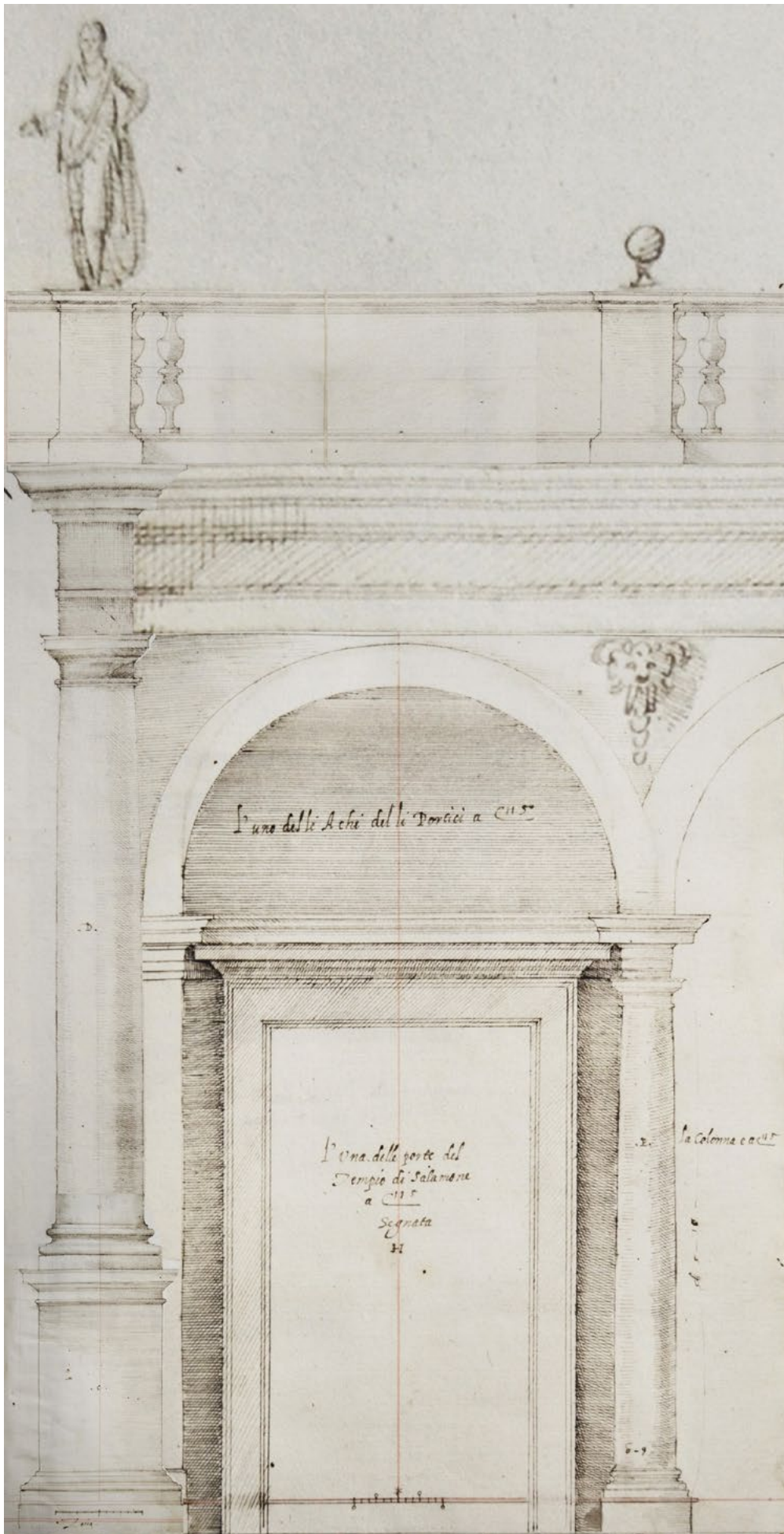
Figura 2.106 - Galeazzo Alessi e collaboratori, Ordine dorico nella piazza del Tempio di Salomone . Elaborazione da: LM 119, 120, 123, 124
