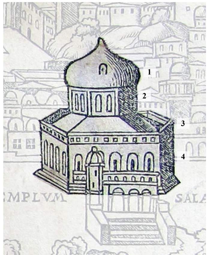
Figura 3.94 - Anonimo, Veduta di Gerusalemme, silografia, 1518 ca. Frontespizio di: Viaggio 1518 . In evidenza la Cupola della Rocca ( Templum Salomonis ). Legenda: 1. cupola; 2. tamburo; 3. balaustrato; 4. decorazioni ad archi nelle pareti esterne dell'ambulacro.
