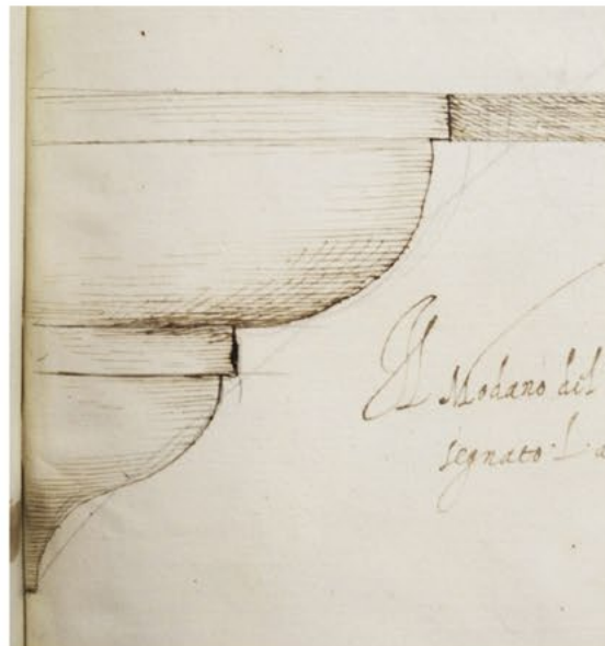
Figura 1.106 - Galeazzo Alessi e collaboratori, Modano della cornice sommitale della cappella dell' Apparizione ai Discepoli . LM 294. Lo schema mostra le diverse fasi di redazione del foglio: 1. Linee di impaginato in inchiostro rosso; 2. Linee di costruzione in matita nera; 3. Linee di contorno a penna e inchiostro; 4. Ombreggiature; 5. Segnature e didascalie.
