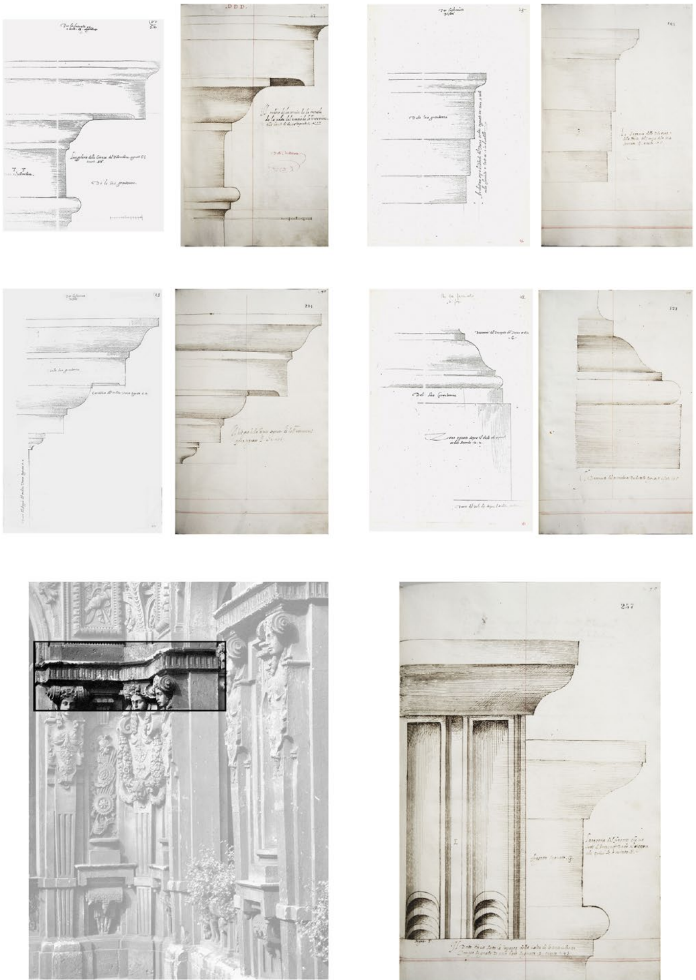
Figura 1.107 - Confronto fra alcune sagome disegnate nel Libro dei Misteri ed architetture progettate da Galeazzo Alessi: le modanature per la chiesa di Santa Maria presso San Celso e la trabeazione del primo piano del cortile di Palazzo Marino a Milano. LM 57, 165, 284, 121, 257; BaMi, Raccolta Bernardino Ferrari, S 149 Sup B, 62, 45, 43, 42.
