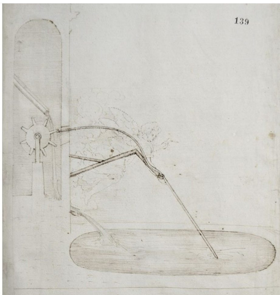
Figura 3.132 - Galeazzo Alessi e collaboratori, Progetto per la Probativa Piscina , sezione con dettaglio dell'automata dell'angelo, LM 139.
