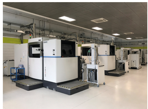
Fig.4 - Una parte del reparto di SLM di BEAMIT presso lo stabilimento di Rubbiano di Solignano (PR)
