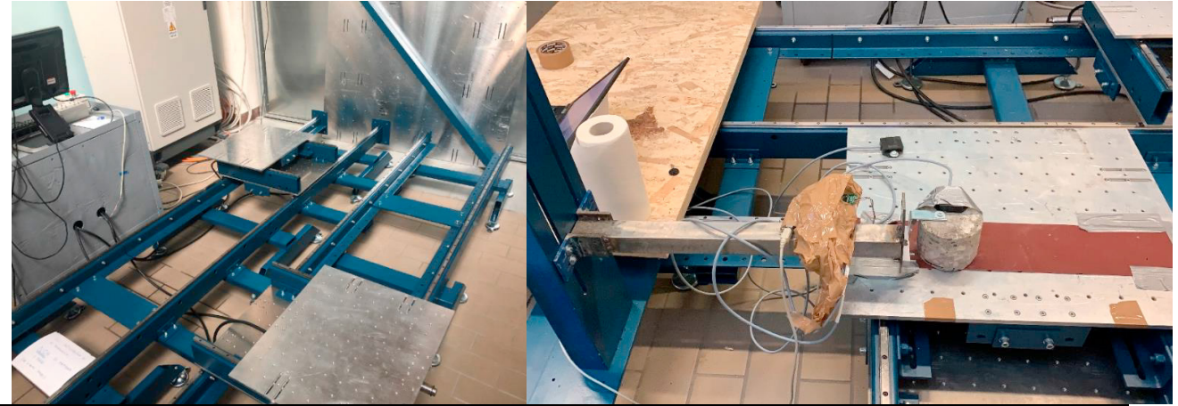
Figure 3. Shacking table at the Politecnico di Torino.
