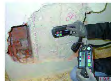
Magnetometria con pachometro – foto IDES Interventi Antisismici
