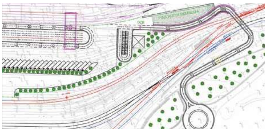
Figura 12. Dettaglio viabilità di accesso e zona d'ingresso.
