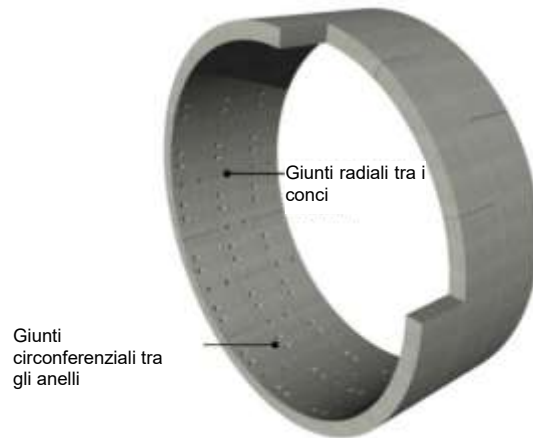
Figura 3-1. Schema di rivestimento in conci prefabbricati con indicazione dei giunti longitudinali (tra i conci) e circonferenziali (tra gli anelli dei conci) (Groeneweg, 2007).
