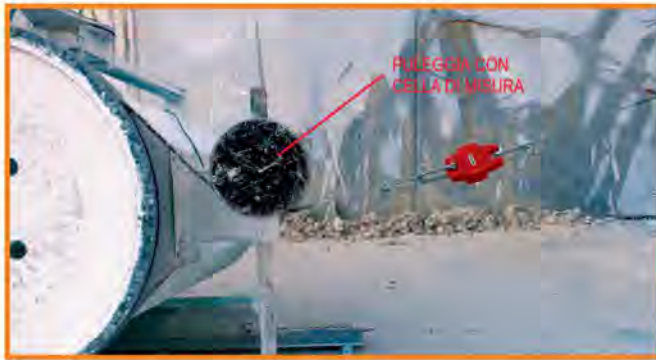
Fig.5 Taratura con dinamometro / Calibration with a dynamometer
