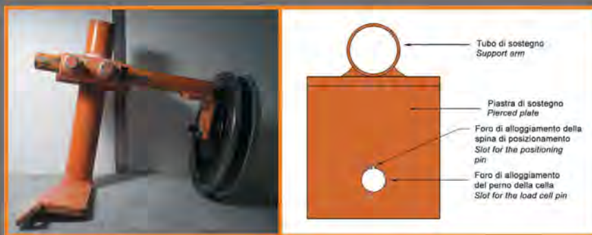
Fig.3 A sinistra, braccetto di sostegno della puleggia con cella di carico. A destra, rappresentazione schematica della piastra di fissaggio della cella di carico / On the left, support arm of the pulley with the load cell. On the right, schematic representation of the load cell fixing plate
