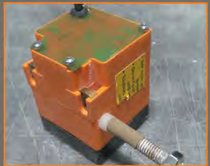
Fig.6 Estensimetro a filo (modello A40 prodotto dalla Kubler). Intervallo di misura 1000 mm, velocità massima 0,8 m/s, accuratezza \pm 0,15 mm, linearità \pm 0,35\% , intervallo di temperatura 0°-50° / Draw-wire encoder (model A40, produced by Kubler). Measuring range: 1000 mm, maximum speed: 0.8 m/s, accuracy: \pm 0.15 mm, linearity: \pm 0.35\% , temperature range: 0°-50°
