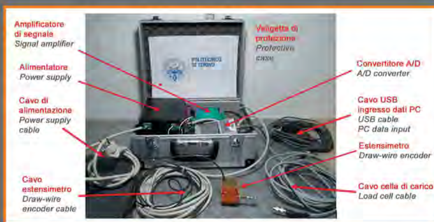
Fig.7 Valigetta di protezione degli strumenti e cavi di collegamento Protective case and instrument connection cables
