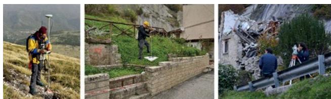
Figura 5. La misura di punti di appoggio a terra mediante ricevitore GNSS in modalità RTK, e misura di punti di dettaglio con Total Station.
