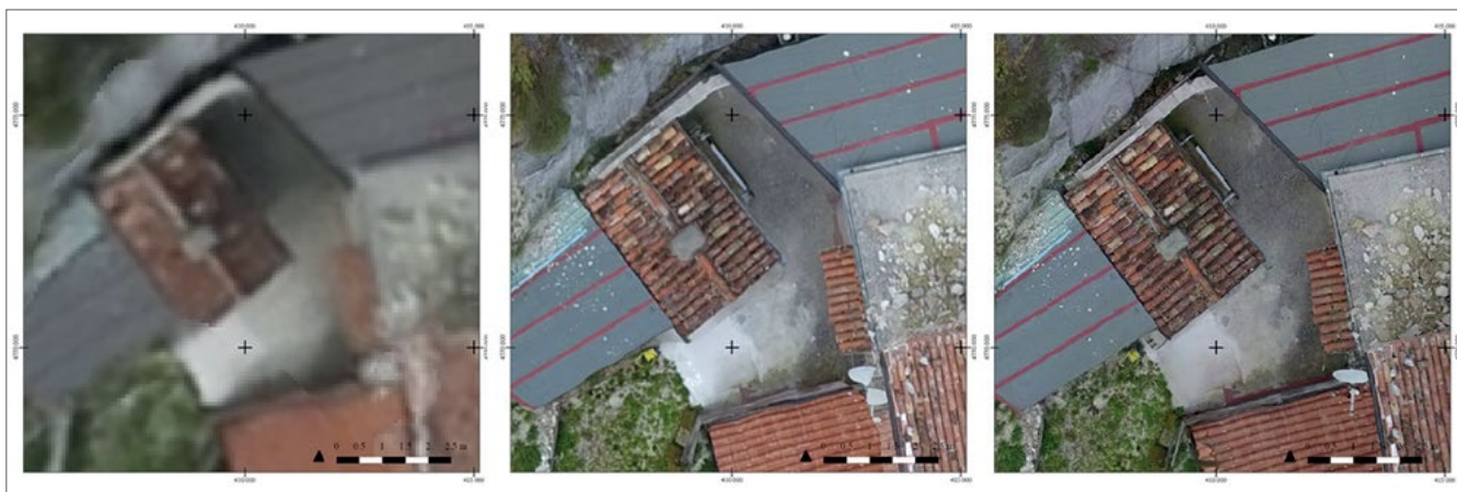
Figura 1. Comparazione di estratti di ortofoto elaborate da diversi voli fotogrammetrici, eseguiti a diverse quote di volo e mediante droni di differente tipologia: ala fissa eBee, GSD_{medio}=5 cm/px (sx); quadri-cottero DJI Phantom, GSD_{medio}=2,18 cm/px (centro); ortofoto da modello fuso, GSD_{medio}=0.92 cm/px (dx).
