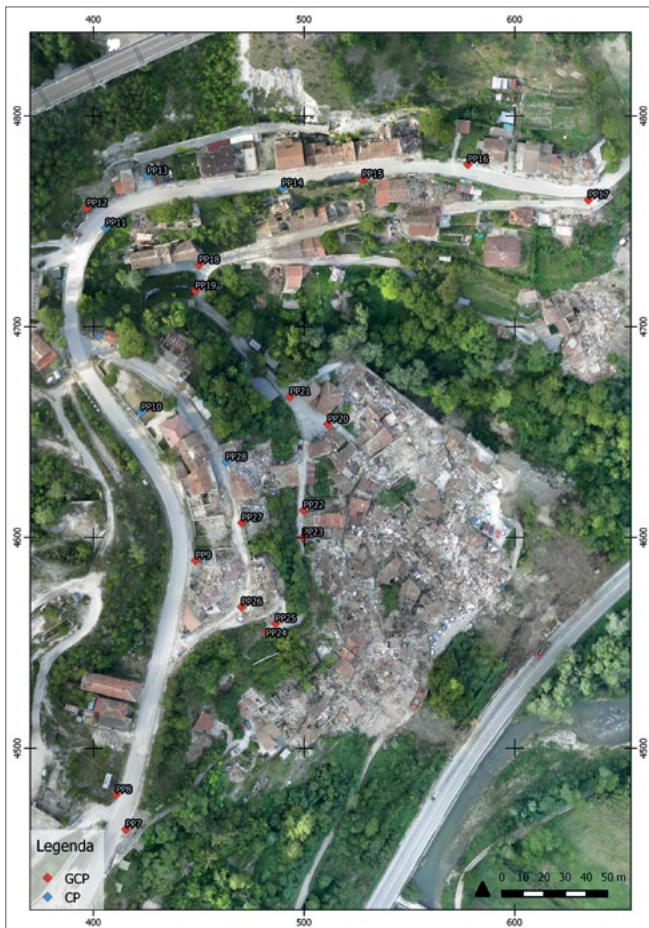
Figura 8. Distribuzione dei punti di controllo sul territorio di Pescara Del Tronto e differenziazione tra i punti utilizzati come GCPs e quelli utilizzati come CPs.
