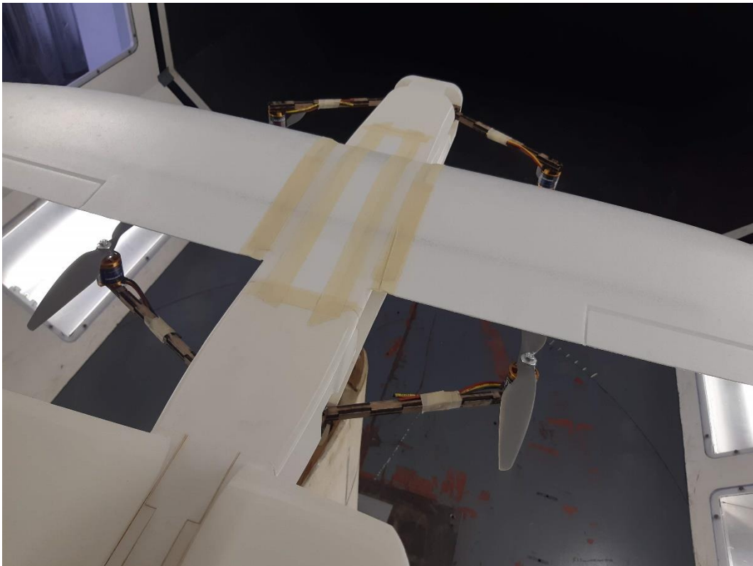
Figure 110: Mini Talon 2, propellers out 60°.
