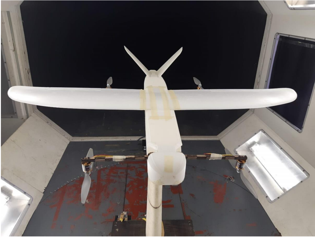
Figure 111: Mini Talon 2, propellers out 90°.
