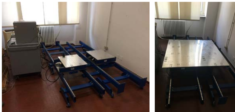
Figure 3. Shaking table at Politecnico di Torino.
