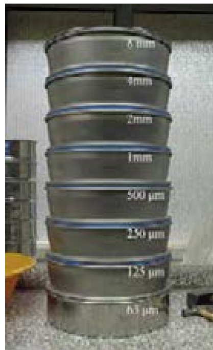
figg. 48, 49 e 50 – Disgregazione e riduzione del campione. Serie di setacci di prova con dimensione delle aperture.
