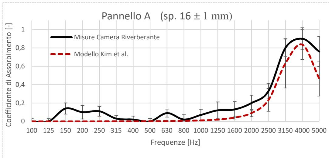
Figura 4 – Confronto tra i risultati ottenuti con la camera riverberante sul pannello A (spessore  $16 \pm 1$  mm) e la media dei risultati ottenuti applicando il modello per gli spessori di 15, 17 mm - Comparison of the results obtained with the reverberation room on panel A (thickness  $16 \pm 1$  mm) and the average of the results obtained applying the model for 15, 17 mm thickness.
