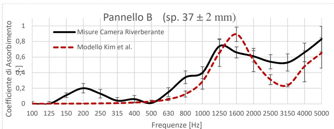
Figura 5 – Confronto tra i risultati ottenuti con la camera riverberante sul pannello B (spessore  $37 \pm 2$  mm) e la media dei risultati ottenuti applicando il modello per gli spessori di 35, 37, 39 mm - Comparison of the results obtained with the reverberation room on panel B (thickness  $37 \pm 2$  mm) and the average of the results obtained applying the model for 35, 37, 39 mm thickness.
