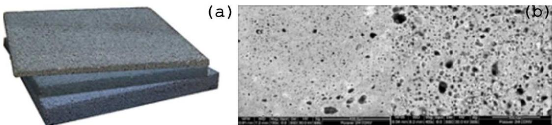
Figura 1 – Pannelli 54x54 cm di diversi spessori, A= $16 \pm 1$  mm, B= $37 \pm 2$  mm, C= $57 \pm 3$  mm (a) e immagine SEM dell'aggregato sezionato (b) – 54x54 cm Panels of three thicknesses, A= $16 \pm 1$  mm, B= $37 \pm 2$  mm, C= $57 \pm 3$  mm (a) and SEM image of the aggregate section (b).
