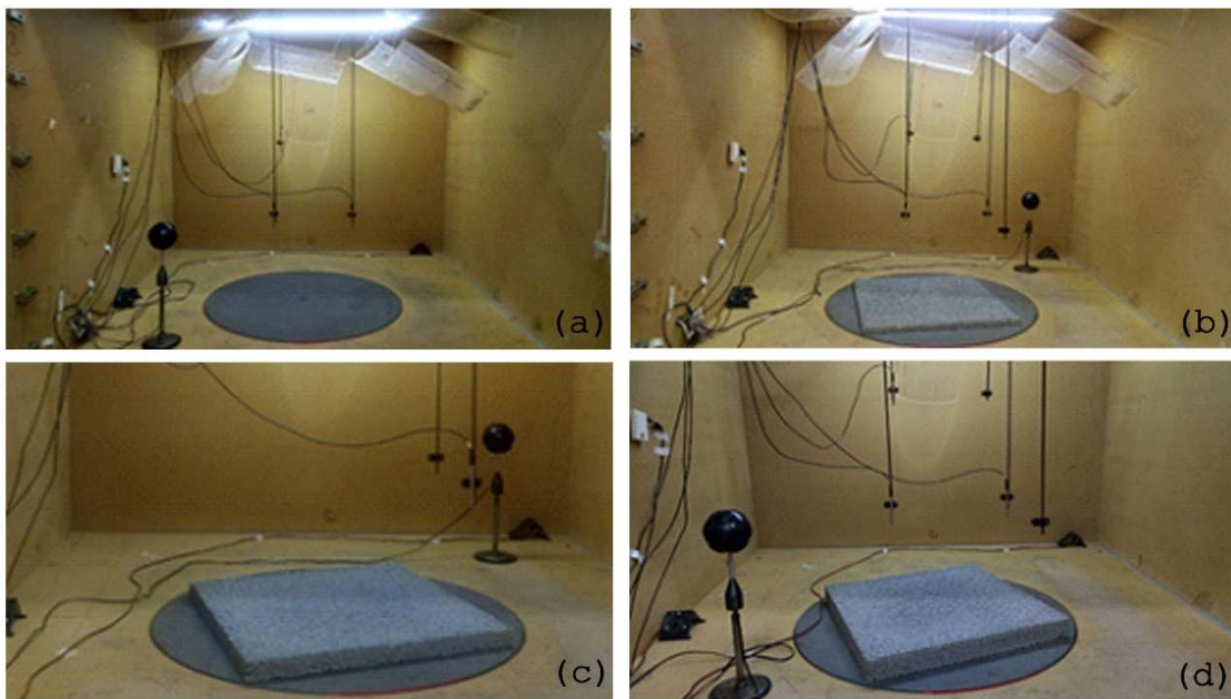
Figura 3 – Camera riverberante in scala 1:5 senza il campione (a) e con il campione A (b), con il campione B (c) e con il campione C (d) (Dip. di Energia, Politecnico di Torino) – 1:5 scaled reverberation room without the sample (a) and with the measured sample A (b), Sample B (c) Sample C (d) (Dep. of Energy, Politecnico di Torino).
