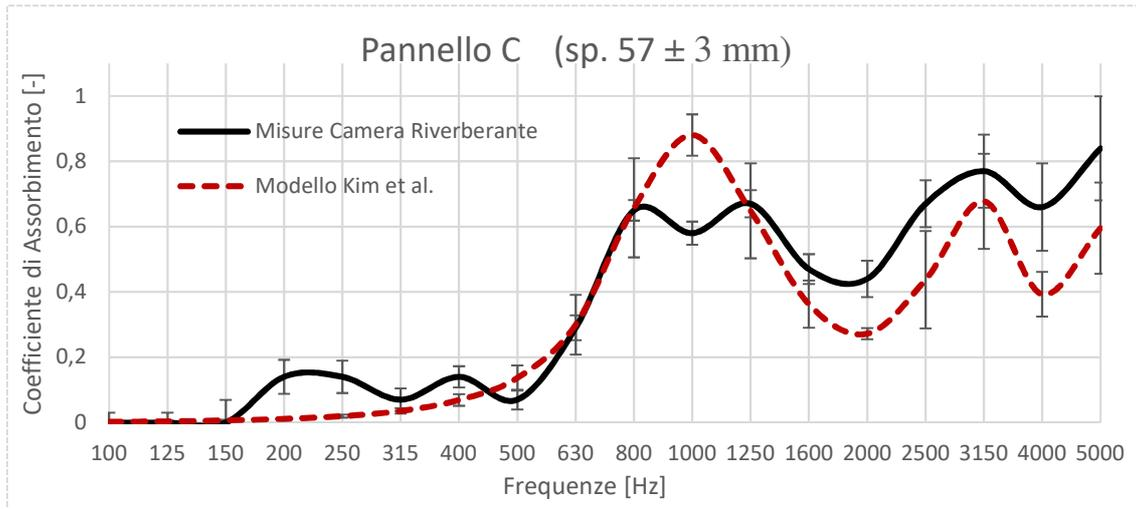
Figura 6 – Confronto tra i risultati ottenuti con la camera riverberante sul pannello C (spessore  $57 \pm 3$  mm) e la media dei risultati ottenuti applicando il modello per gli spessori di 54, 57, 60 mm - Comparison of the results obtained with the reverberation room on panel C (thickness  $57 \pm 3$  mm) and the average of the results obtained applying the model for 54, 57, 60 mm thickness.
