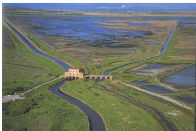
Fig. 5 - Il Padule di Castiglione della Pescaia (GR) con la Casa Rossa, struttura settecentesca, di committenza granducale, per la pesca e la regolazione del livello delle acque (foto C. Bonazza, 2005)
