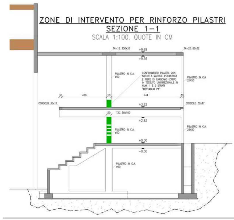
15. Intervento di progetto, sezione rinforzo pilastri.
