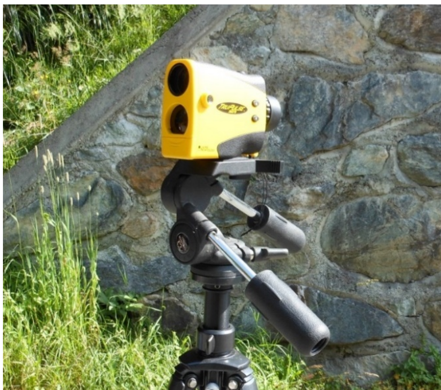
Figura 2.1 – Esempio di telemetro laser (Lasertech Trupulse 360B, Laser Technology, Centennial, Colorado, USA) installato su di un treppiede fotografico in alluminio.
