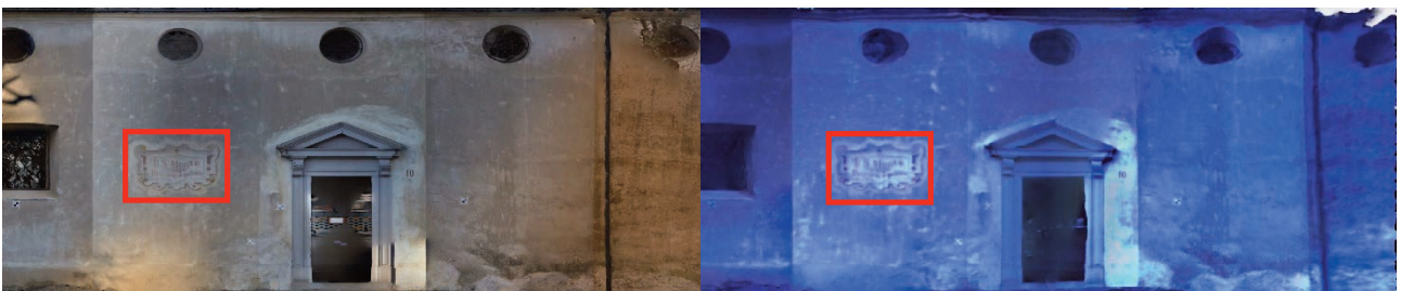
Figura 9 – Confronto tra due ortofoto (proiezione cilindrica) di una porzione del modello della cappella 10, generate a partire dal dataset fotogrammetrico aereo/terrestre (sinistra) e dal dataset della feature tracker camera (destra). In rosso, la porzione della superficie muraria riportata in dettaglio in figura 10.
