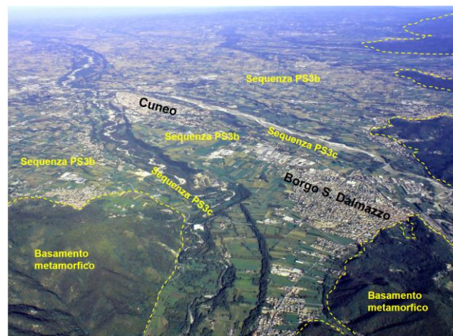
Foto 5.44 - La pianura cuneese ai piedi delle Alpi Liguri, costituita dai depositi pleistocenici delle "Alluvioni della pianura principale" della Sequenza PS3, e solcata dai torrenti Stura e Gesso con i relativi depositi olocenici.
