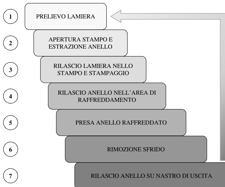
Fig. 1-13: Sequenza delle fasi di un ciclo di produzione.
