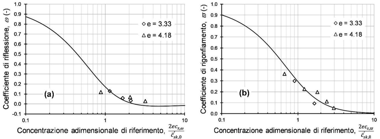
Figura 2. Valori del coefficiente di riflessione (a) e del coefficiente di rigonfiamento (b) ottenuti dalle due prove chimico-osmotiche (indicatori vuoti), e interpretazione teorica con  $\bar{c}'_{sk,0} = 110 \text{ mmol} / \text{L}$  (linea continua).
