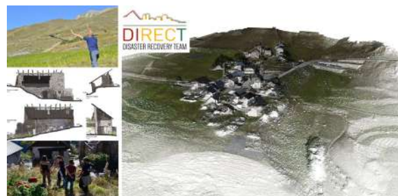
Figura 2. Attività e alcuni esiti del progetto di rilievo metrico 3D a Ferrere in val Stura. (da sinistra in alto: utilizzo di droni ad ala fissa per rilievi fotogrammetrici, elaborati a scala architettonica dal rilievo LiDAR terrestre, rilievi topografici per il controllo metrico del rilievo integrato, nuvola di punti colorata generata dal processo fotogrammetrico di immagini aeree, relativa al borgo di Ferrere
