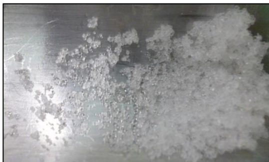
Fig. 3.7 – Microsfere ibride a fine procedura di scambio di solvente
