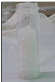
Figura 5.3 – Cilindretto di vetro riempito di microsfere di alcolgel pronte per essere inserite nell'autoclave.
