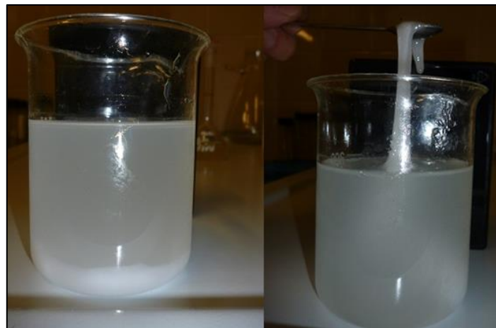
Figura 4.4 – Esito di una prova di formazione di microsfere di Ca-Alg/HPMC. La dispersione non uniforme del \text{CaCO}_3 ha portato ad una reticolazione parziale del Na-Alg: le microsfere, dopo il loro recupero, sono diventate un agglomerato. Nell'immagine di destra il sistema è stato portato a 70^\circ\text{C} per far diventare bianca l'HPMC rendendo visibile l'agglomerato.
