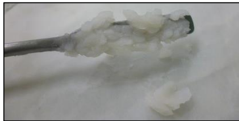
Figura 2.7 – Microsfere ottenute dalla fase di recupero. Come si può vedere, a causa delle eccessive impurezze, le microsfere hanno l'aspetto di una poltiglia.
