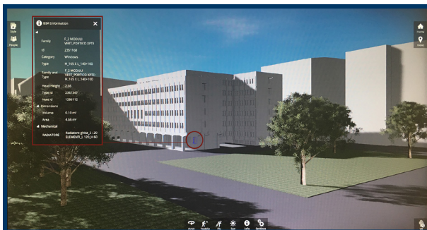
Fig. 6. Visualizzazione delle proprietà alfanumeriche del modello BIM attraverso la Realtà Virtuale (elaborazione grafica degli autori).
