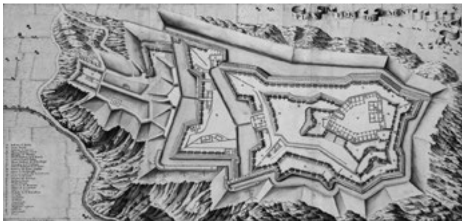
Fig. 1. Il forte di Demonte dopo i lavori di Pinto di Barri. Il roccione fu sagomato e reso inaccessibile in diversi punti, mentre un buon numero di artiglierie furono schierate in casamatta (ASTo, Corte, Carte topografiche e disegni, Carte topografiche segrete , Demonte, 33A(II) rosso).
